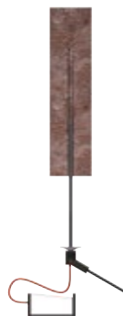
2. Podłączenie do uchwyty instalacyjnego i wprowadzenie kotwy OMEGA-BOLT® do otworu
