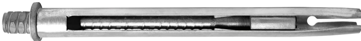
Conçu et développé en Australie pour les mines de roche dure souterraines. Le boulon D47 Mechanical Dynamic Extra (MDX) possède une extension supplémentaire inégalée pour un ancrage extrêmement efficace grâce à sa conception avec cale unique qui peut s'étendre jusqu'à 60 mm. Le boulon D47 MDX est particulièrement adapté aux conditions de roches sismiques et constitue la nouvelle référence en matière de stabilité du support terrestre dans des conditions sismiques.
