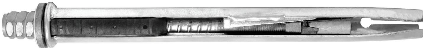
Le boulon D47 Mechanical Dynamic (MD) est un boulon de friction de 47 mm renforcé d'une barre de 20 mm et d'une disposition avec cale à l'extrémité supérieure. Une fois le boulon complètement enfilé dans le trou (comme un boulon de friction), l'écrou au bas est tourné pour actionner un jeu de cales qui fixent fermement l'extrémité supérieure du boulon dans la roche.
